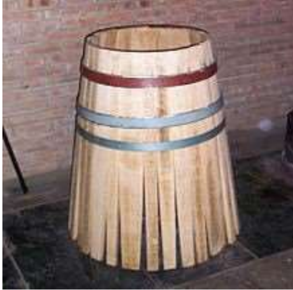
निर्माण के अधीन बैरल का मध्य भाग।
