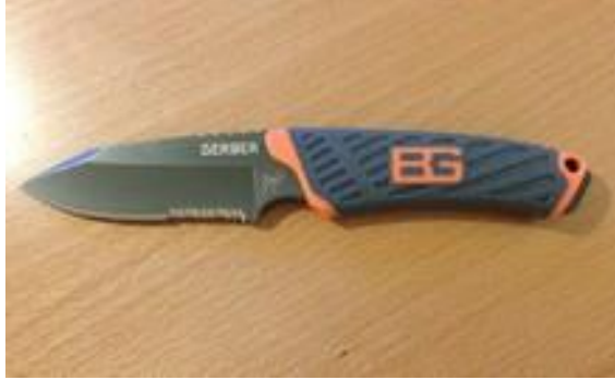
एक गेरबर-निर्मित फुल-टैंग सर्वाइवल चाकू। ब्लेड से धातु हैंडल से परे फैली हुई है।
