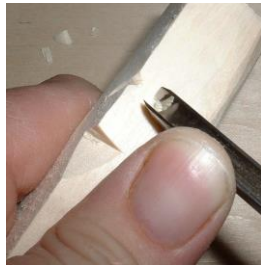
वी-टूल, लाइनों का हिस्सा और वी-आकार के चैनलों को काटने के लिए उपयोग किया जाता है
