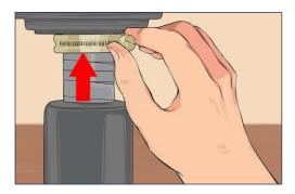
6. कुर्सी का परीक्षण करें। कुर्सी को अब क्लैंप से नीचे स्लाइड करने में असमर्थ होना चाहिए। अंतर्निहित ऊंचाई समायोजन अभी भी ठीक से काम नहीं करेगा। यदि कुर्सी गलत ऊंचाई पर है, तो सिलेंडर पर क्लैंप को ऊंचा या नीचा करें।
