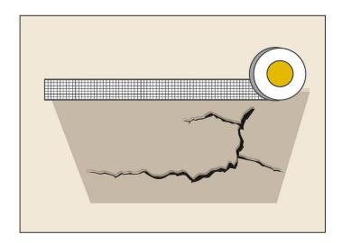
4. सीधे दरार पर मेश ड्राईवॉल टेप लागू करें। यह टेप चिपकने वाला होगा, इसलिए यह आपकी सीलिंग पर मजबूती से चिपक जाएगा। पूरी दरार को कवर करने के लिए टेप की लंबी स्ट्रिप्स का उपयोग करें। वास्तव में, दरार की लंबाई के आधार पर, आप टेप की एक स्ट्रिप का उपयोग करके पूरी चीज को कवर करने में सक्षम हो सकते हैं। टेप को इस तरह लगाएं ताकि यह सीधे दरार पर केंद्रित हो और इसे सीलिंग पर मजबूती से दबाएं। टेप की एक भी परत से अधिक लागू न करें।
