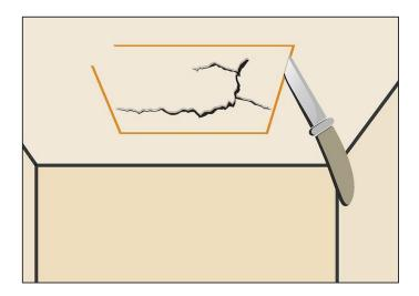
3. एक ड्राईवॉल चाकू के साथ ढीली सामग्री को हटा दें। दरार के पास सीलिंग के खिलाफ लगभग 15 डिग्री के कोण पर अपने 6 इंच (15 सेमी) ड्राईवॉल चाकू रखें। दरार के पास फटे ड्राईवॉल कागज के किसी भी ढीले, बिना कटे हुए टुकड़े के नीचे इसे स्लाइड करें। इनको टुकड़ा करने के लिए चाकू का उपयोग करें, सावधान रहें कि ड्राईवॉल के नीचे के हिस्से को नुकसान नहीं पहुंचे।
