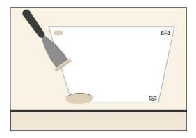
9. अपने नए ड्राईवॉल की सतह पर यौगिक से काम करें। अपने ड्राईवॉल प्रतिस्थापन टुकड़े की सतह पर ड्राईवॉल यौगिक को फैलाने के लिए ट्रॉवेल का उपयोग करें। यौगिक के साथ सीलिंग में सामने की ओर कागज के किनारों पर तब तक काम करें, जब तक कि कोई दिखाई देने वाले पेंच न हों और आप पैच के किनारों को नहीं देख सकते हों।
