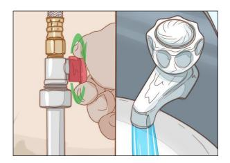
6. पानी की आपूर्ति चालू करें और लीक का परीक्षण करें। पानी की आपूर्ती को दोबारा चालू करने के लिए गर्म और ठंडे शटऑफ वाल्व को वामावर्त घुमाएं, फिर नल के दोनों टैपों को खोलें। पानी को कम से कम 2-3 मिनट तक पूरी शक्ति से चलने दें। इस समय के दौरान प्रत्येक नल टैप के आधार के आसपास लीक की जांच करें। उसके बाद, पानी बंद कर दें और देखें कि नल टपकता है या नहीं।
